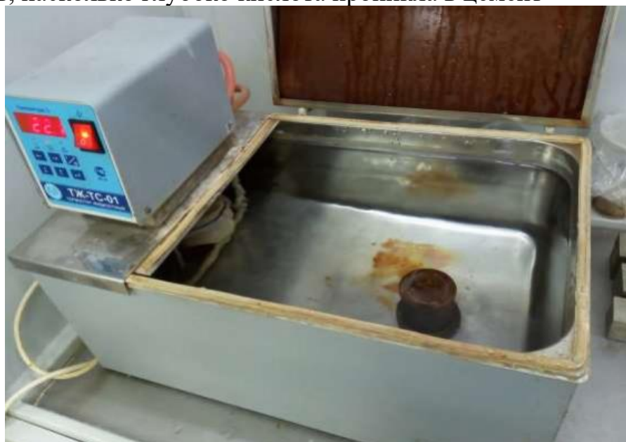
Рисунок 2.3 – Испытание на кислотоустойчивость
