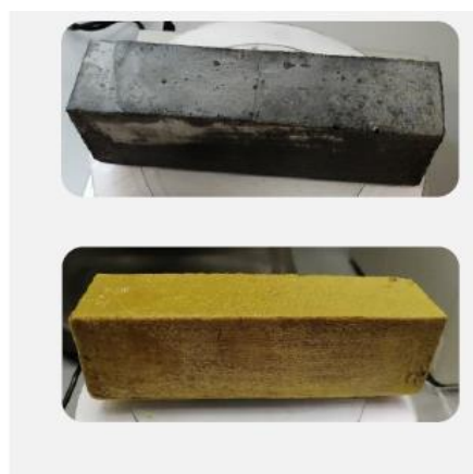
Рисунок 2.4 – Результаты испытания на кислотоустойчивость
